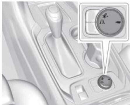
Рукоятка переключателя режимов движения (переднеприводный автомобиль)
